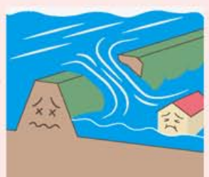
崩れた場所は一気に広がり、勢いよく水が流れ出し、家などに襲いかかります。
