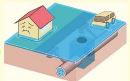
道路にたまる水が増えて宅地に流れ込み建物が浸水します。
