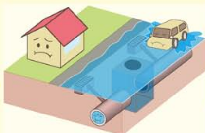
溢れた水が道路にたまります。
