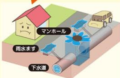
下水道のマンホールや雨水ますから水が溢れます。
