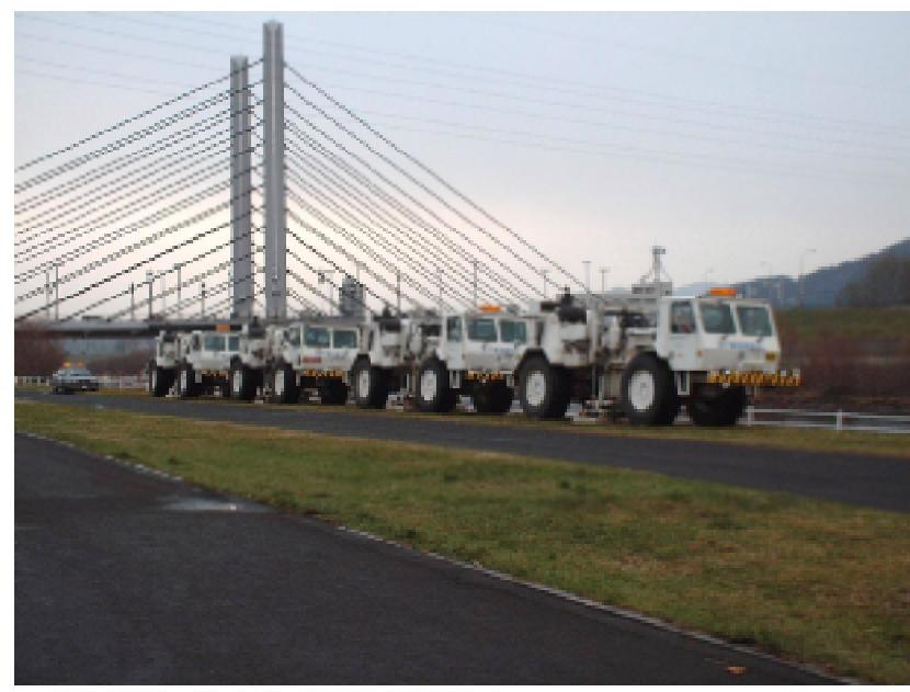
ミュンヘン大橋近くでの反射法地震探査
