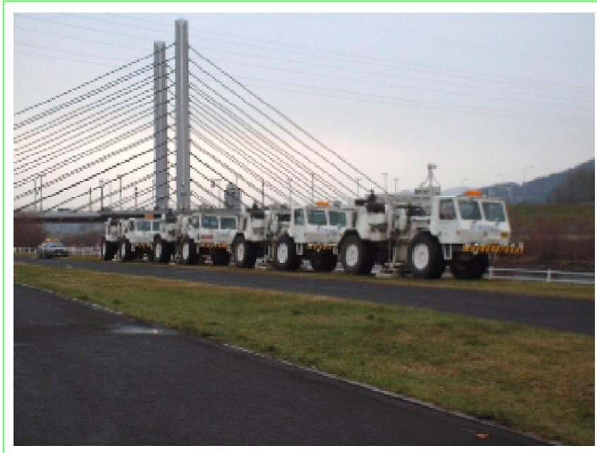
ミュンヘン大橋近くでの反射法地震探査
