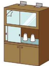
L字金具での固定。ガラス飛散防止フィルムを張る。扉開放防止器具やすべり止めシートで食器の飛び出しを防止。
