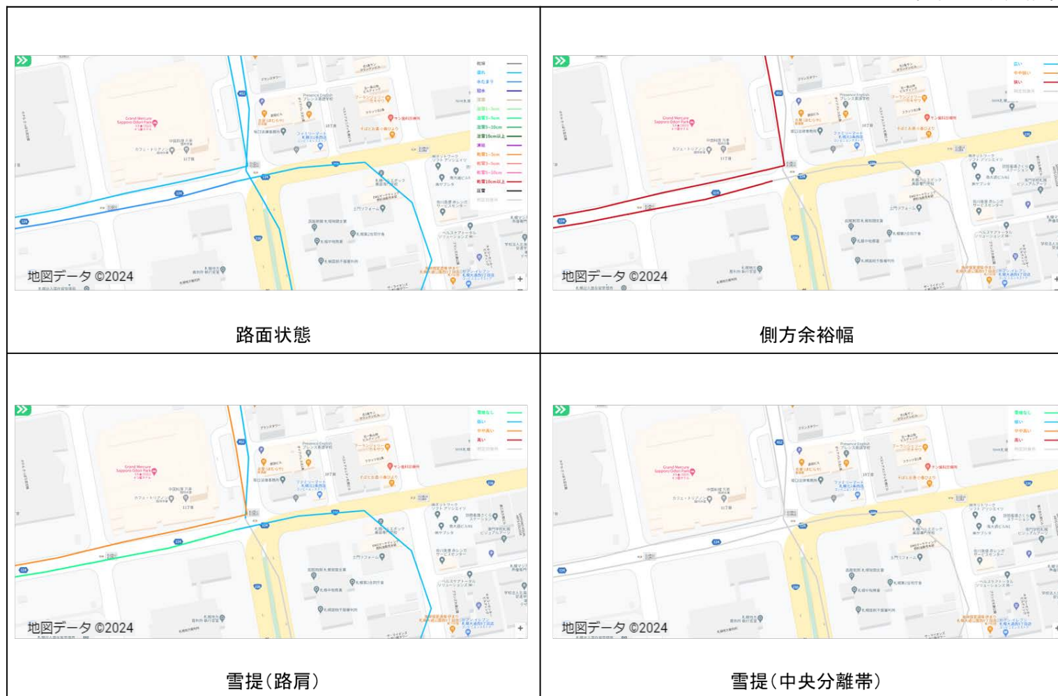
図 3-1-10 AI による路面、道路状況の判定結果 (2024 年 3 月 19 日 14:50 頃)
