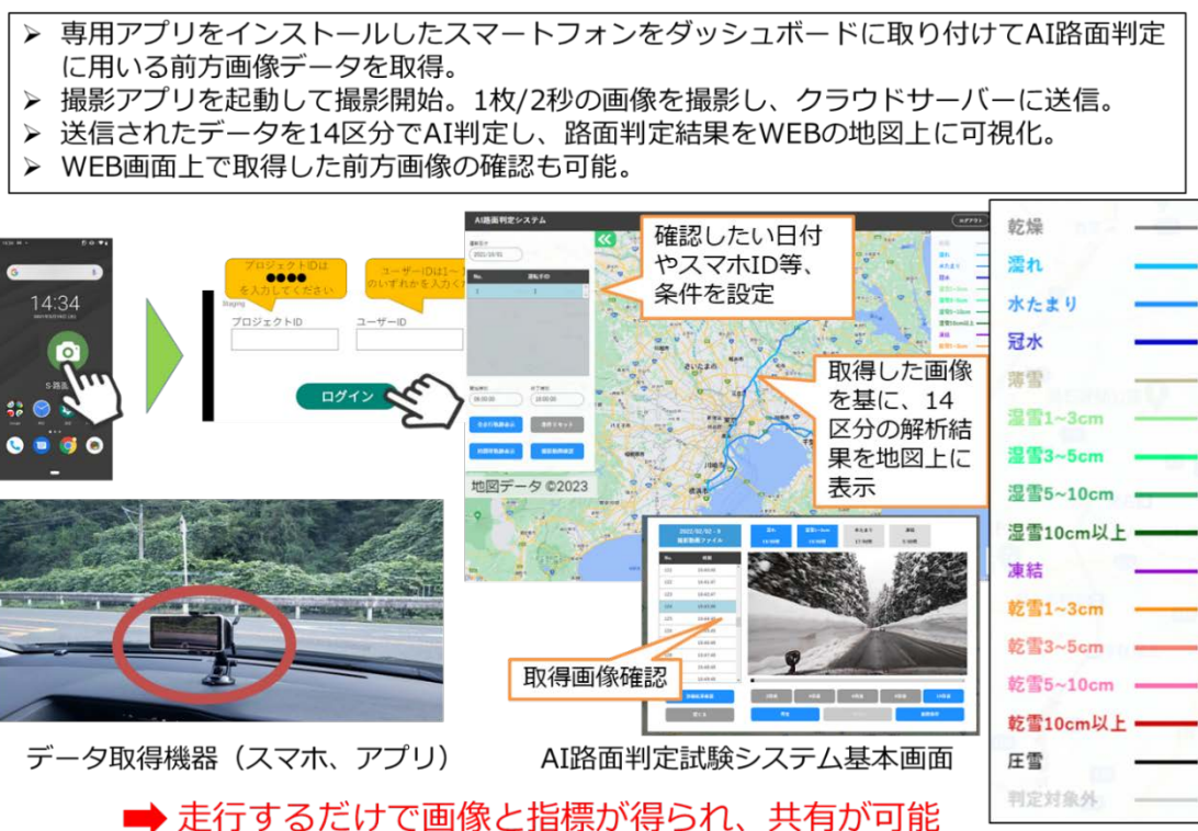
参考図 1 AI 路面判定試験システムの概要
