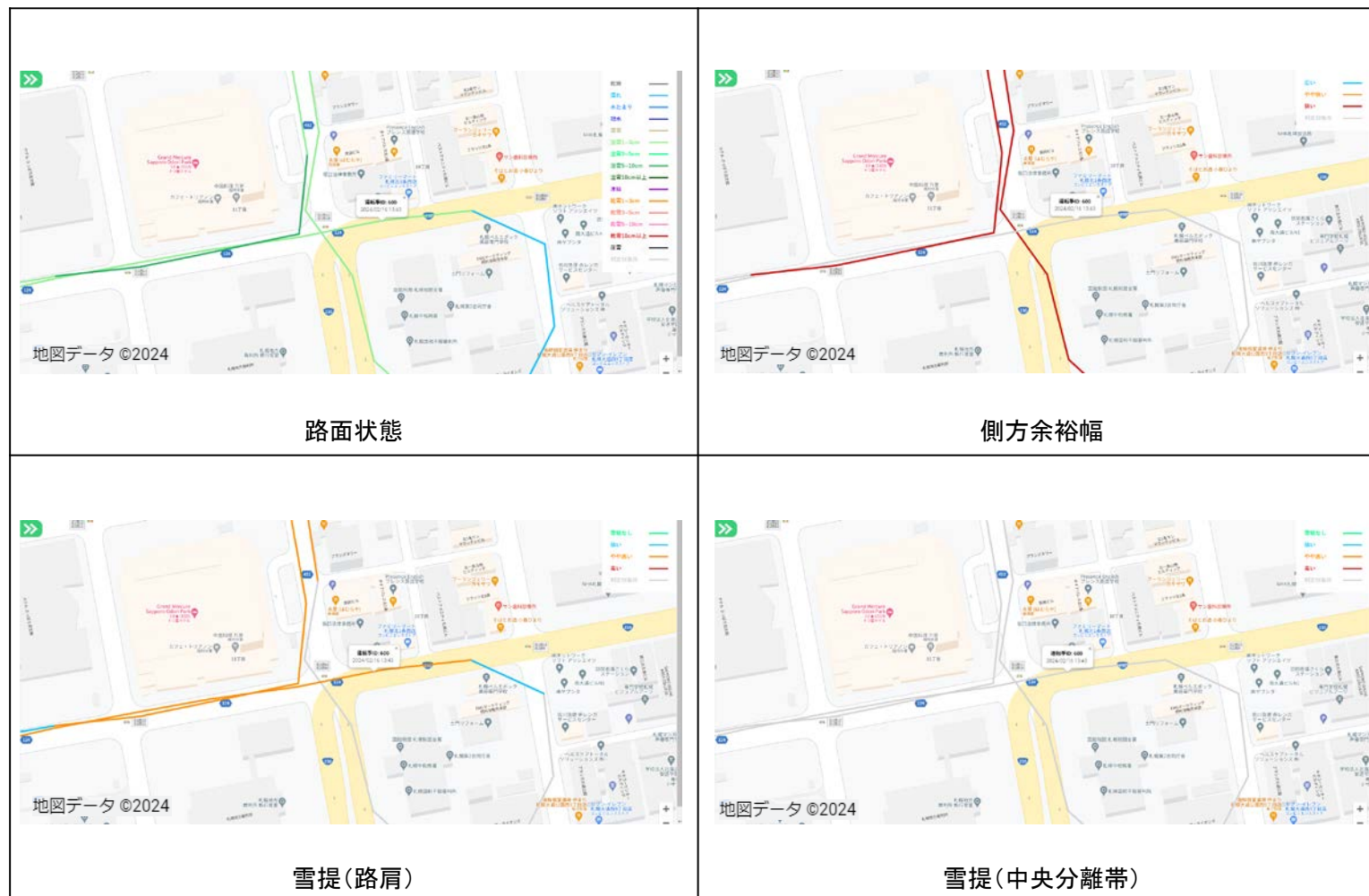
図 3-1-7 AI による路面、道路状況の判定結果 (2024 年 2 月 16 日 13:40 頃)
