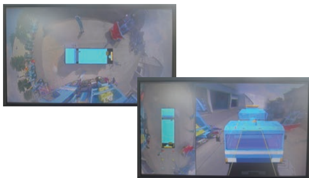
俯瞰的に除雪機械を確認する装置のモニター画面 〔株〕ネクスコ・エンジニアリング北海道さんの製品
