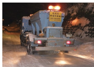
滑り止め材散布の様子
