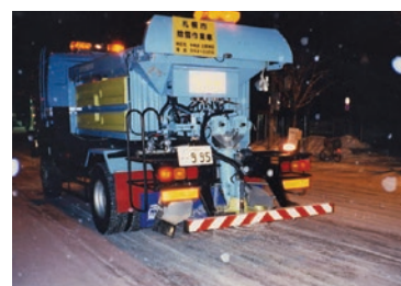
凍結防止剤散布の様子
