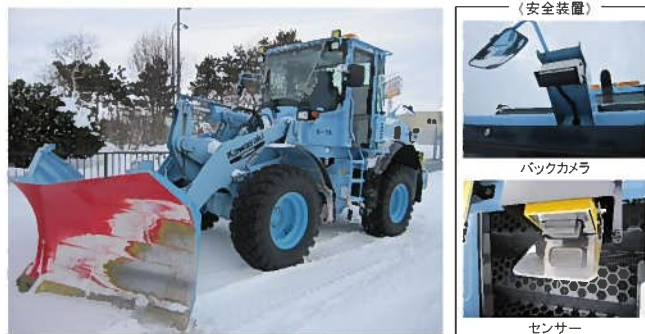
1人乗り化除雪機械（タイヤショベル）
