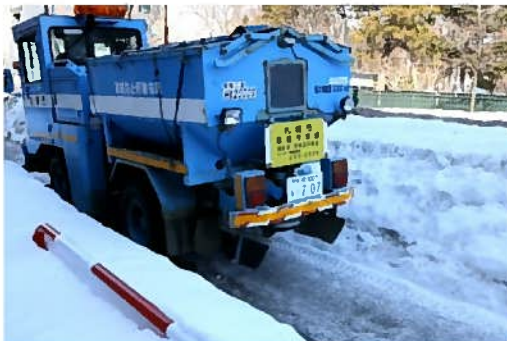
滑り止め用砂の散布作業(歩道)
