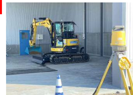
図：汎用測量機器を活用した小型ICT建機
