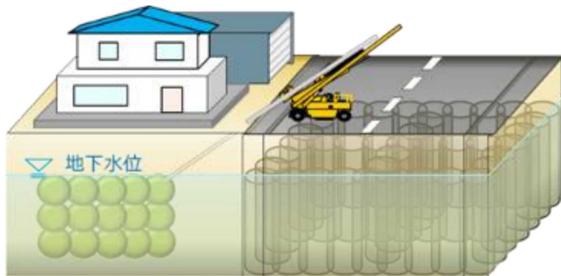
【宅地】薬液注入 【道路】深層混合処理
