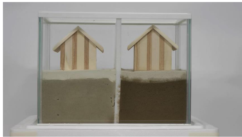
薬液注入による液状化被害の抑制効果
