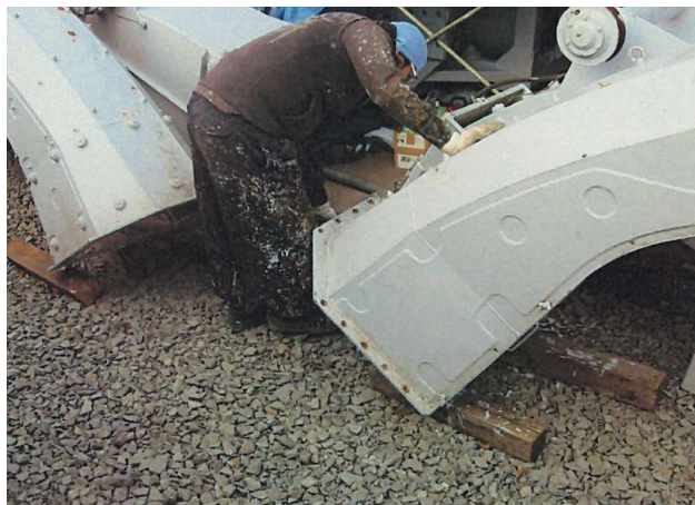
ロータリー排雪シュート部塗装作業状況②
