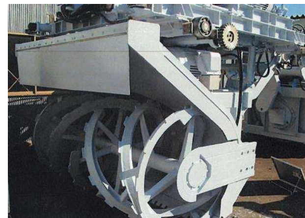
ロータリー補修塗装完了状況②
