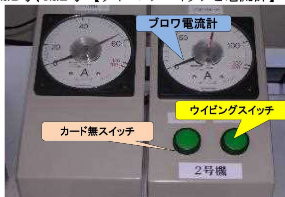
No.1号、No.2号 【ウイビングスイッチと電流計】
