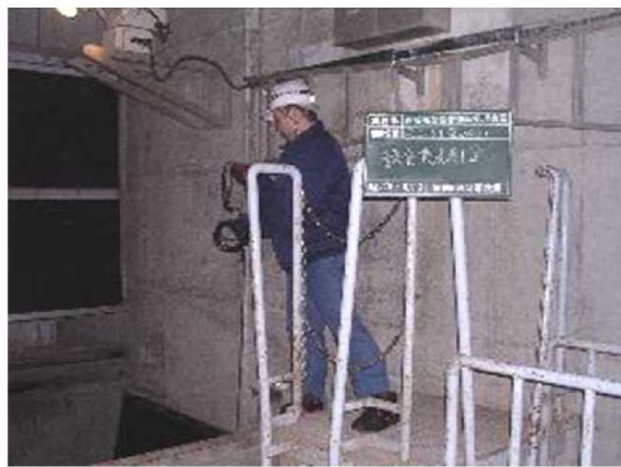
酸素濃度等測定(②No.2ロータリー室)
