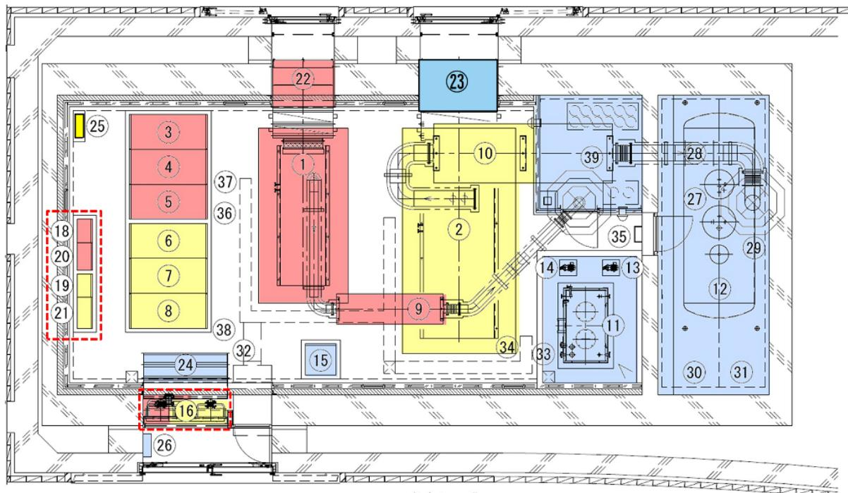
«地下発電機室内 設備配置図»
