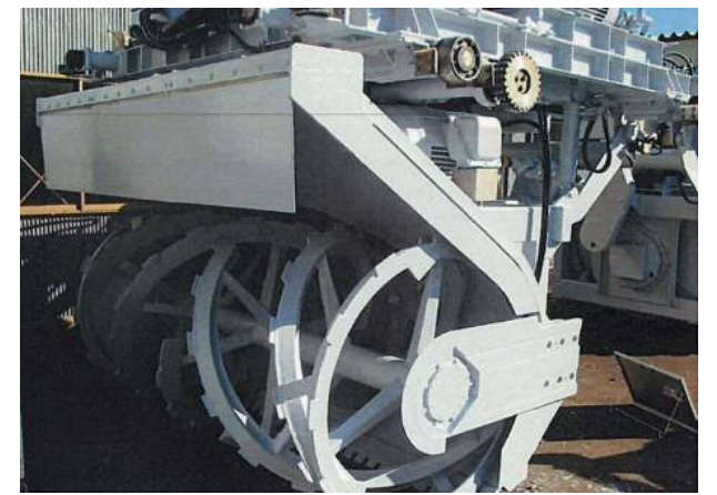
ロータリー補修塗装完了状況②
