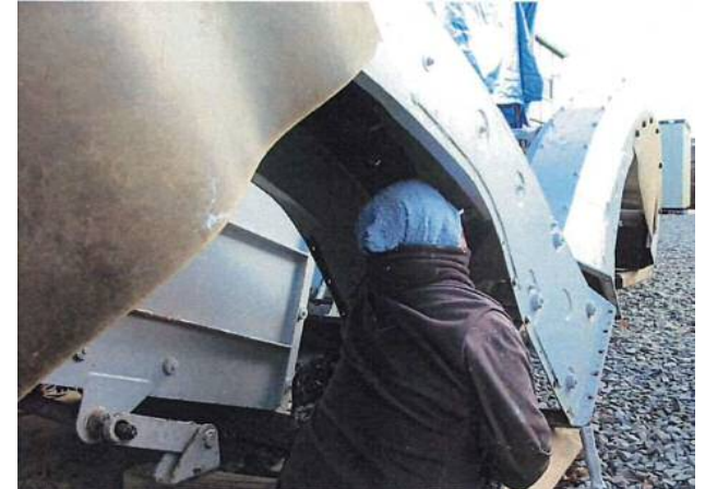
ロータリー排雪シュート部塗装作業状況①
