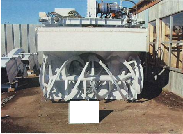
ロータリー補修塗装完了状況③
