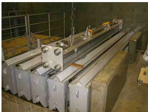
堰上げ、清掃後保管状況
