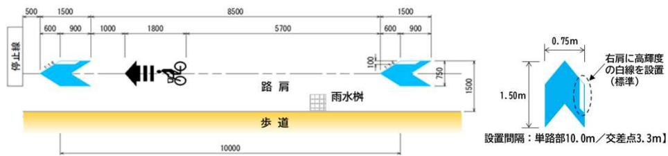
図 矢羽根型路面表示の標準整備図
