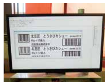
印字内容を設定する画面。 段ボールを挟み込むようにして側面に印字する
