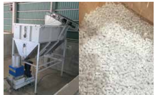
対馬市で漂着する発泡スチロール製パイを燃料化する樹脂圧縮成型機「ステラ」と製造された樹脂燃料
