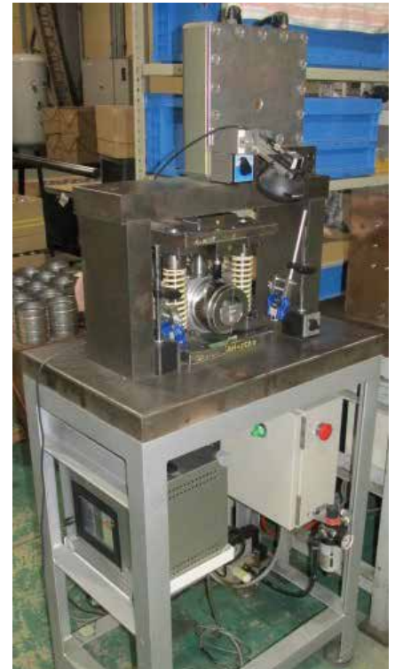
円筒に穴を開ける製品加工機。中央の円い部分に円筒をセットし、上部のカメラセンサーで位置の正確性を確認する
