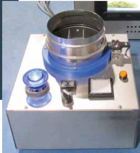
円筒を中央の円い部分に置いて、穴の位置を確認。同時にOリングの有無も確認できる
