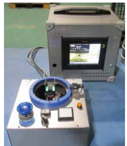
製品チェックを行う検査機。良/不良で画面に「OK」/「NG」の表示と検査機本体のランプが緑/赤に点灯する。
