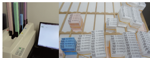
「切り出し」工程でのカセットへの印字を自動化
