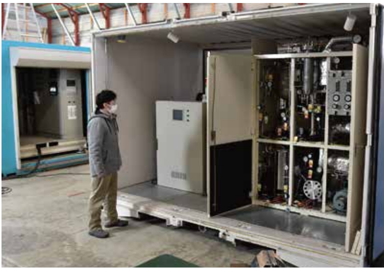
有機ハイドライド技術により、水素を用いた移動可能な発電ユニット
