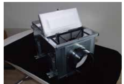
現在、開発中のハイブリッド換気装置。最善の換気方法に自動で切り替わる
