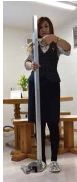
試作中のレベルマーキング装置
