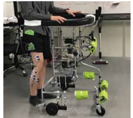
アシスト強度検証のため実験機で筋電位計測
