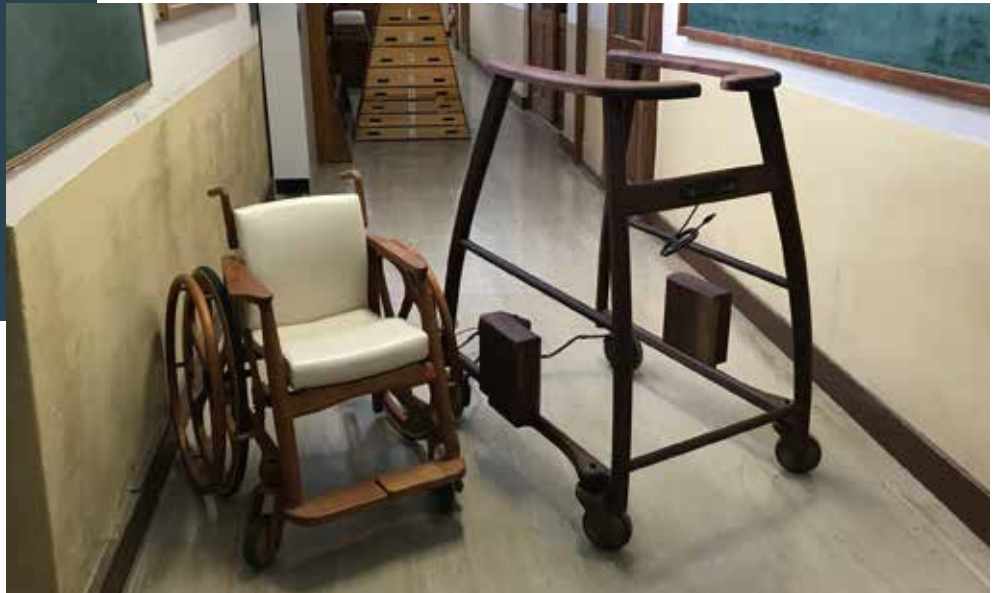
試作開発した自動運転の木製歩行器(右)と、「家具工房 旅する木」の木の車椅子(左)
