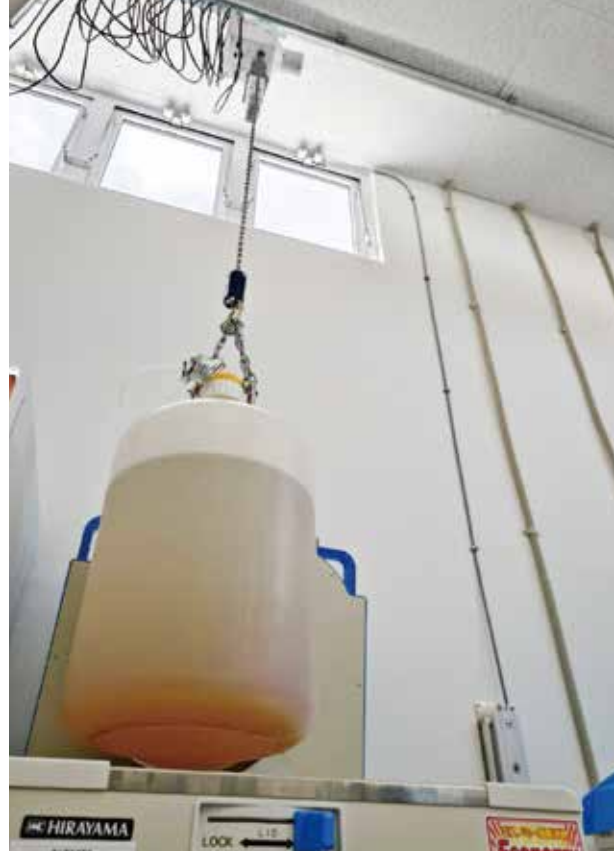
121℃で加熱滅菌した培養タンクを移動させるムーンリフタ。
