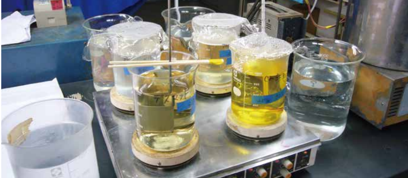
テストピースで試作するための陽極酸化処理装置。耐食性、耐汚染性などを向上させるため封孔処理を行う。
