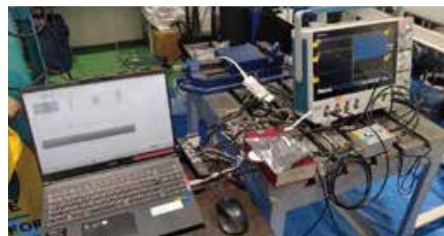
圧力変化と音響信号を同時にオシロスコープにて記録。
