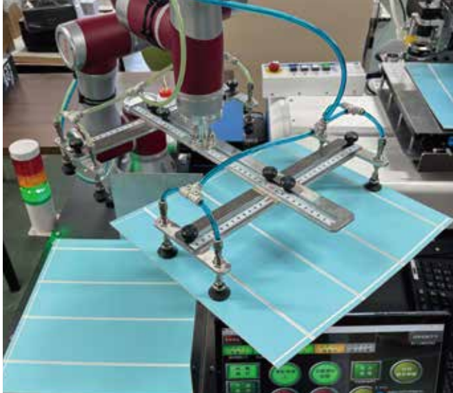
糊付けの位置を0.1mm単位で調整することができる。
