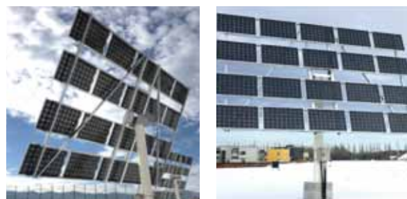
追尾式両面太陽光発電システム実証機
