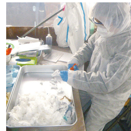
処分の法的期限が迫るPCB（ポリ塩化ビフェニル）分析の様子。シーリング材や塗料など、あらゆる容器の分析に対応している。
