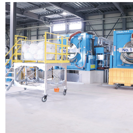
石狩市の工場にある使用済み紙おむつの分別・処理に特化した機械システム。処理後はプラスチックと紙だけの状態になり、様々な用途でリサイクルされる。
