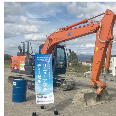
バイオ系次世代燃料「RD100」を使用した重機。既存の重機でもそのまま活用が可能であり、GHG排出量を最大90%削減できる。
