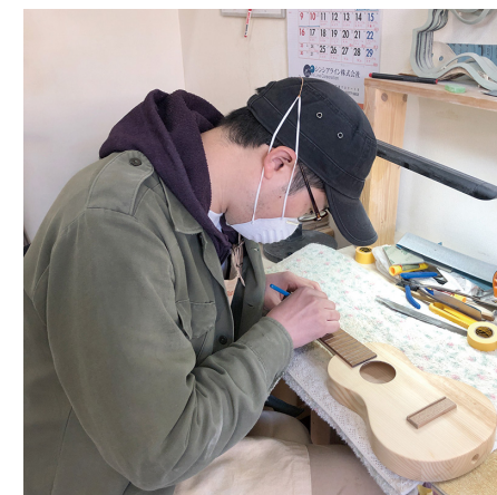
ウクレレ作りの様子。NC加工機で切り出したスルーネック構造のウクレレを、職人が手作業で丁寧に仕上げていく。
