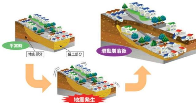
滑動崩落の図解(国土交通省「宅地耐震化の取組に関するパンフレット」より引用)
