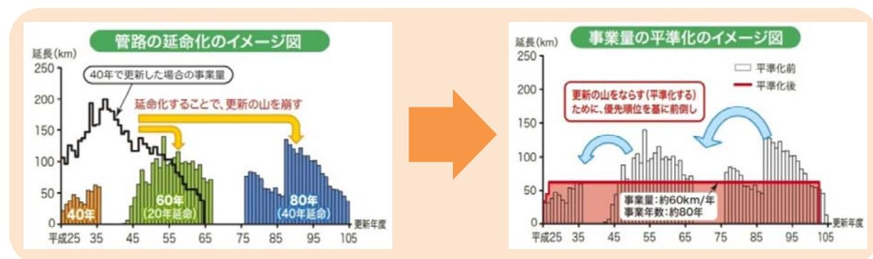
図○ 配水管の延命化と更新事業量の平準化
