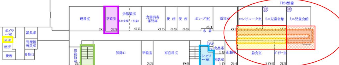
※図は検体採取の位置図です。調査の結果、アスベストの含有が認められる仕上げ材と同工事内で同材料を使用している箇所は、アスベストを含有しているものとしています。
