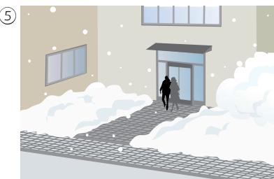
敷地内に雪の堆積スペースを確保し、ロードヒーティングを設置した計画
