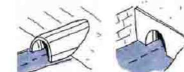
参考)左:突出型トンネル 右:面壁型トンネル
