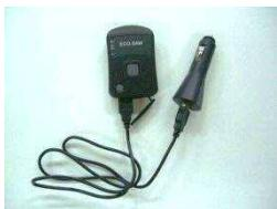
：シガーソケットに取り付けて得た自動車の運行データから、運転者の運転のクセ、粗さなどを可視化できる機器で、従業員、事業所ごとのエコドライブ実施状況を把握、指導を行うもの。令和元年度は各社に2か月間貸し出し、運転評価・診断を含めた支援を行う。
