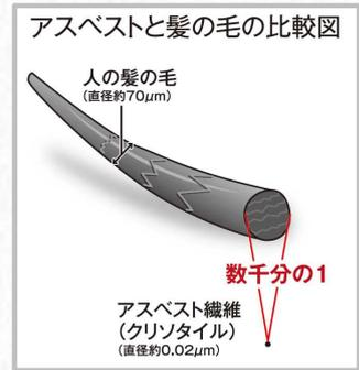
**浮遊した石綿繊維を吸い込まないようにするため、石綿含有建材を取り扱う際には、適切な飛散・ばく露防止措置が必要とされている。**
