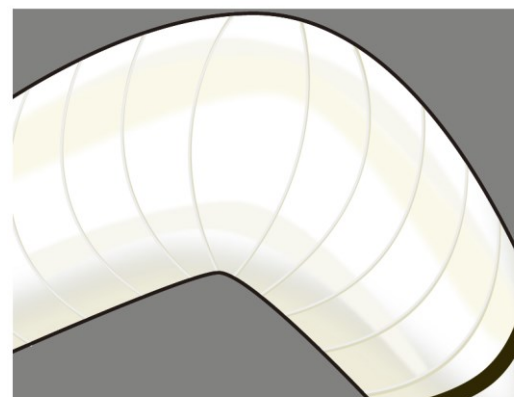
〈配管エルボの保温材〉
