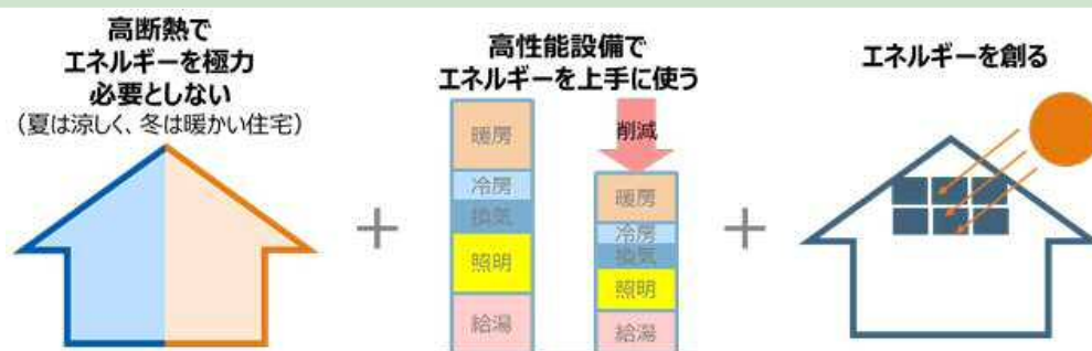
図 6-2 ZEH（ネット・ゼロ・エネルギー・ハウス）の概要
