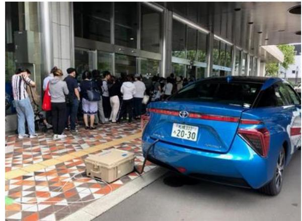
市役所本庁舎内で実施した携帯電話の充電サービスの電源として、本庁舎非常用発電機と併せて公用車FCVから給電
