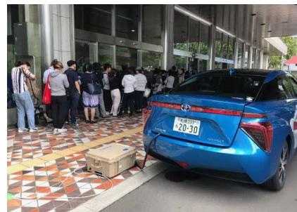
FCV・EVなどは、非常用電源としても活用することが可能であり、平成30年の北海道胆振東部地震による大規模停電の際には、市役所本庁舎で実施した携帯電話の充電サービスの電源として、札幌市公用車のFCVが活用されました。
