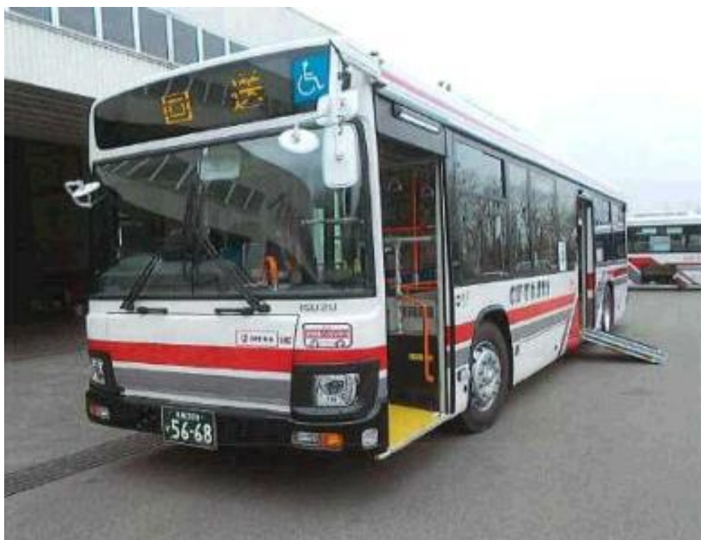
ノンステップバス： 出入口の段差を無くして乗降性を高めた低床バス
