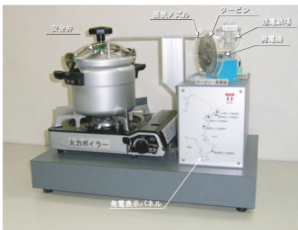
火力発電モデル実験器
