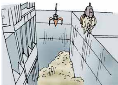
ごみピットとごみクレーン
