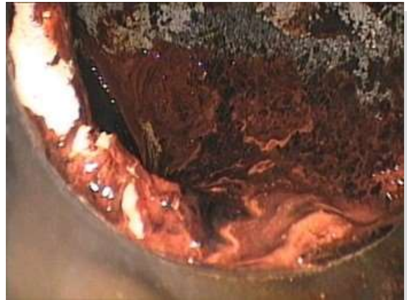
給排水設備の配管の腐食状況
