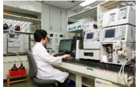
高速液体クロマトグラフ装置による食品添加物の分析
