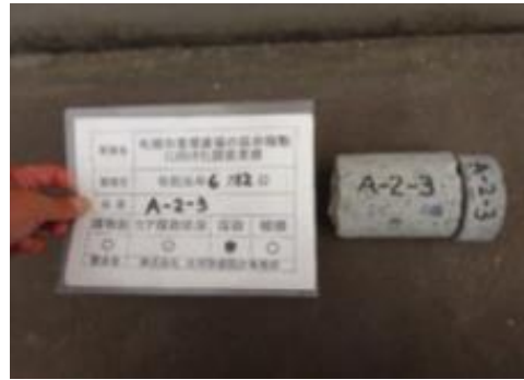
抜いたコンクリート破片
