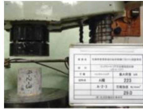
コンクリートの強度試験
