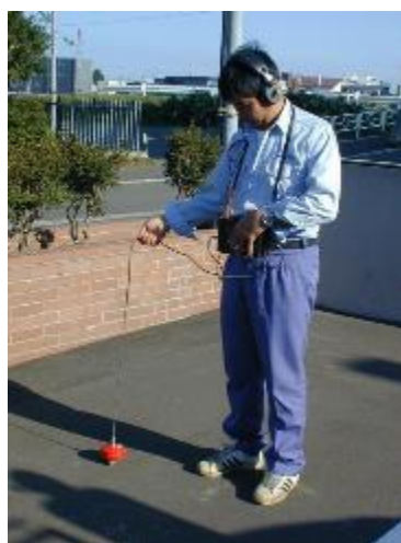
漏水探知機による調査
