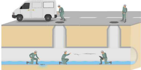
下水道本管の潜行目視調査
